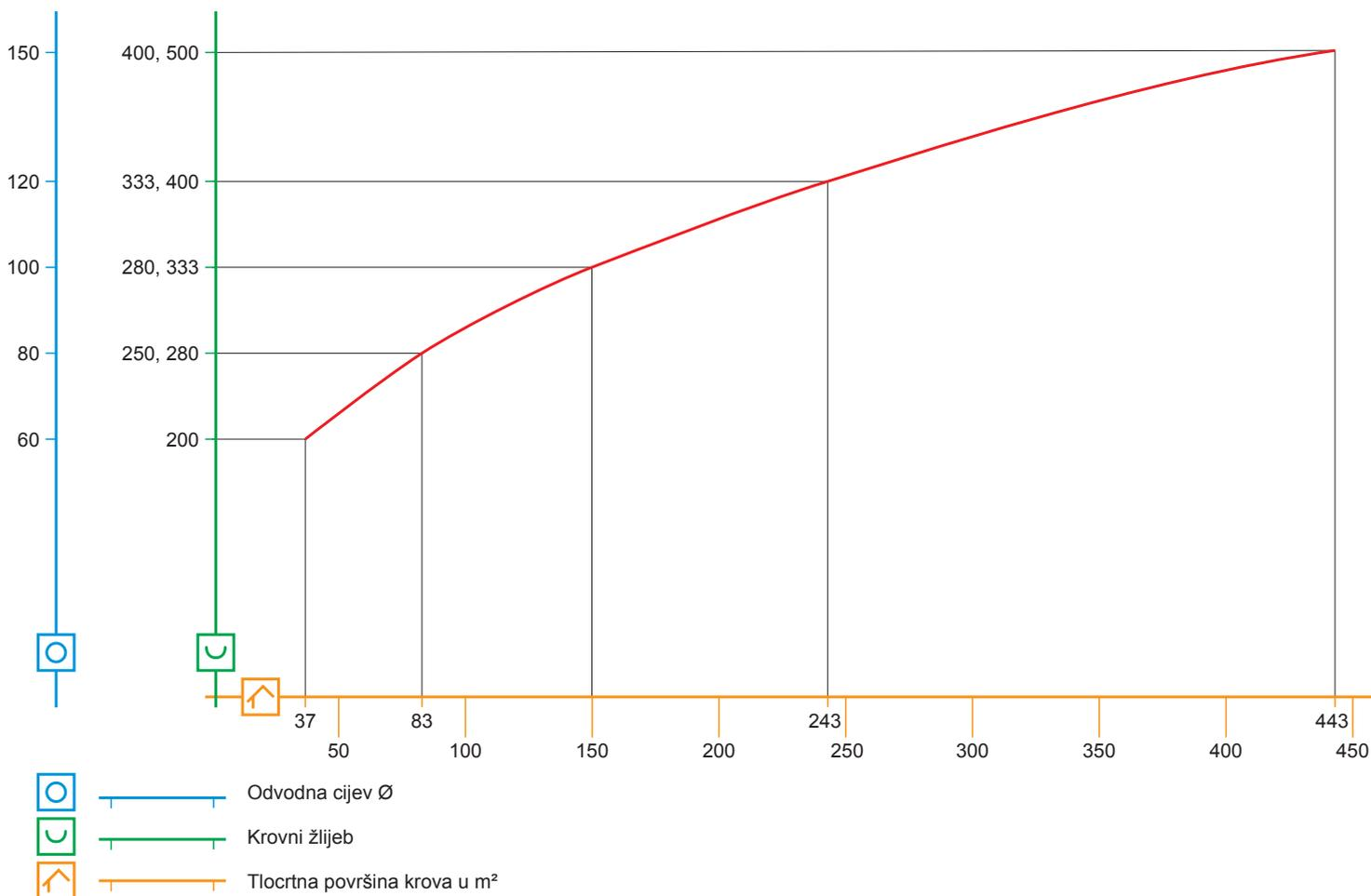
Osnove za dimenzioniranje definirane su u DIN 1986. Grafikon prikazuje pojednostavljeno određivanje potrebnih veličina odvodnih cijevi ovisno o odvodnji područja tlocrtna površine krova.
